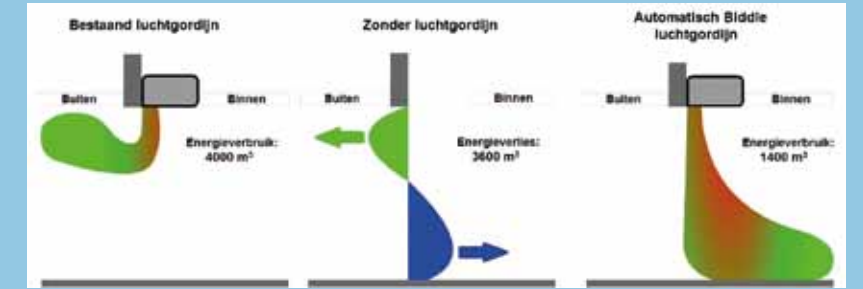
Figuur 1: Energieverbruik (m 3 ) per jaar in deuropening
